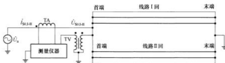
图 13 同塔双回线路两相零序短路阻抗测量
