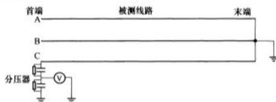
图 1 末端短路条件下工频感应电压测量
